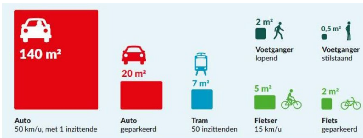
Figuur 1 Ruimtegebruik verschillende modaliteiten (bron: Gemeente Amsterdam)
