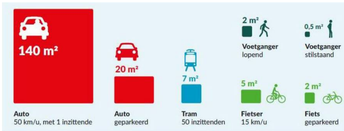
Figuur 1 Ruimtegebruik verschillende modaliteiten (bron: Gemeente Amsterdam)
